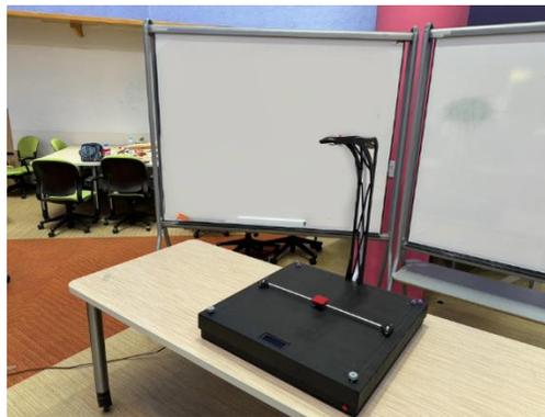
Fig. 4. Prototipo de entrenador biomecánico para reflejos deportivos.
