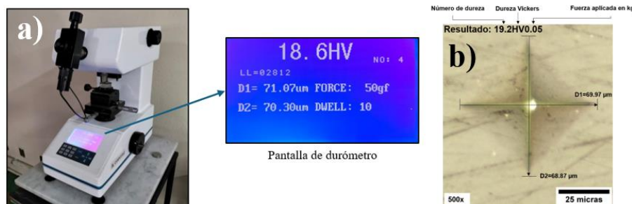
Fig. 5. a) Durómetro Vickers PTS CIENTEC con resolución de 10-1000 gf y b) huella generada por la micro indentación en la muestra 1 con una carga de 50 gf durante un tiempo de 10 segundos (DWELL).
