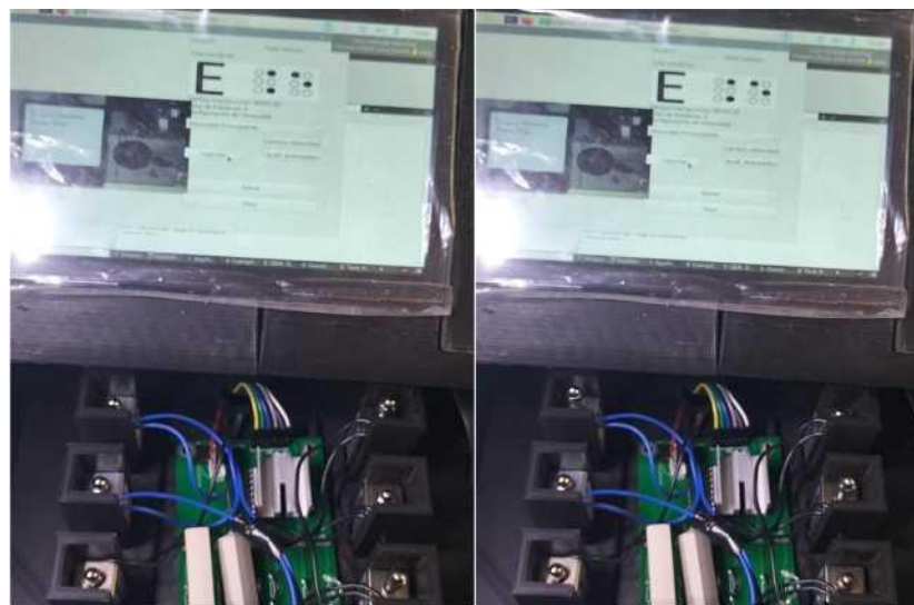
Fig. 15. Implementación de los actuadores para representar la letra E.
