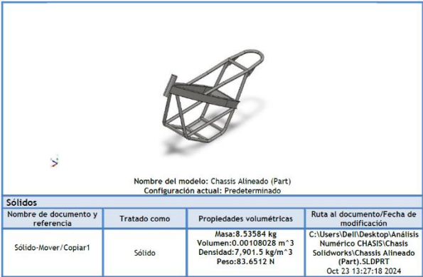
Fig. 6. Información del chasis (Acero AISI 1018).
