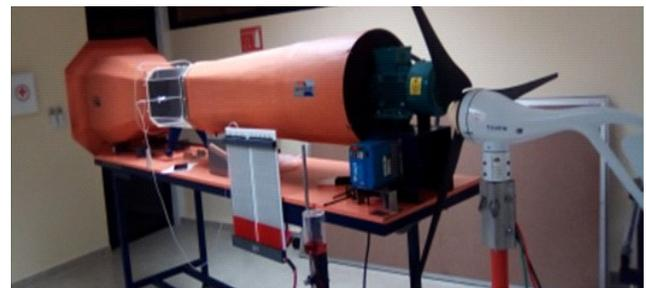
Fig. 3. Montaje del túnel de viento sobre la mesa de trabajo (equipo naranja) y turbina eólica Air X (carcasa blanca, con aspas negras).
