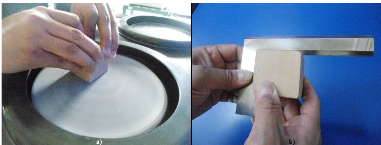
Fig. 4. a) Lijado de una probeta; b) Verificación de una probeta.
