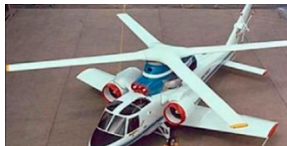
Fig. 3. Fotografía del Sikorsky X-wing [14].
