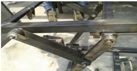
Fig. 3. Acercamiento de las uniones de los eslabones del mecanismo de elevación.
