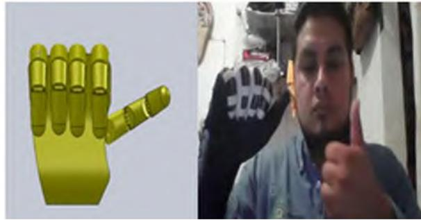
Fig. 13a. Simulación en solidworks y de manera física de cómo se realiza la letra "a", en el lenguaje de señas mexicano.
