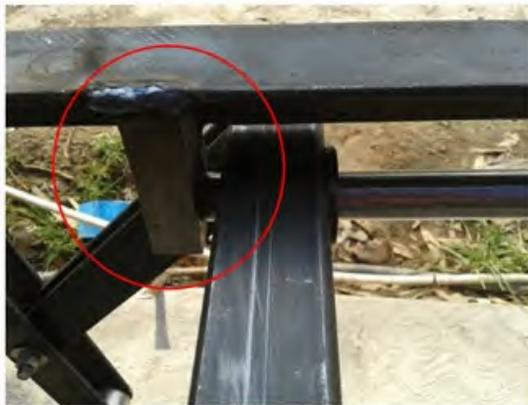
Fig. 5. Soporte de la corredera del mecanismo de elevación.
