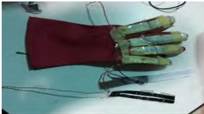
Fig. 6. Prototipo 0: Consiste en un guante de látex con sensores flexible elaborados de grafito de manera casera.
