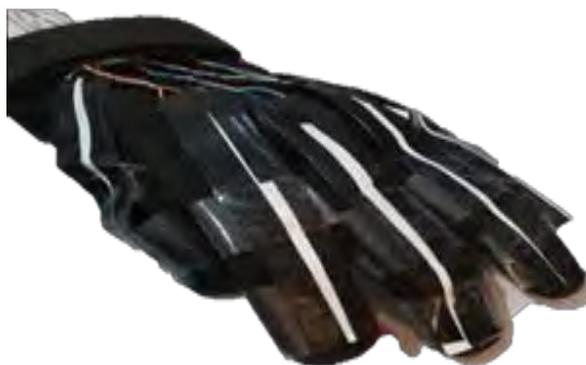
Fig. 7. Prototipo 1: guante textil de algodón con laminillas de cobre.
