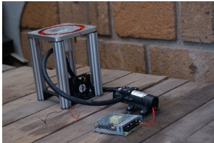
Fig. 11. Sistema de atracción magnética y enfriamiento.
