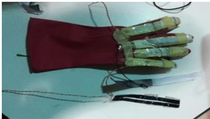
Fig. 6. Prototipo 0: Consiste en un guante de látex con sensores flexible elaborados de grafito de manera casera.
