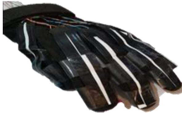
Fig. 7. Prototipo 1: guante textil de algodón con laminillas de cobre.
